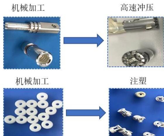
新材料替代原来的 PTFE（聚四氟乙烯）材料，从而使得加工工艺由机械加工转为注塑成为现实。通过持续的工艺创新，公司 5G 板对板射频连接器产品达到了产品性能及价格的良好平衡，在持续降低生产成本的同时，产品的插损、驻波比、阻抗、径向容差、轴向容差等技术指标与灏讯、罗森伯格、雷迪埃、四川华丰等国内外企业指标基本趋同。
